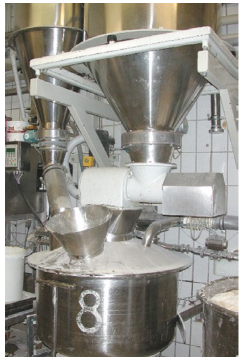
geschlossene Mehlausbringung mit Deckel und Absaugung
