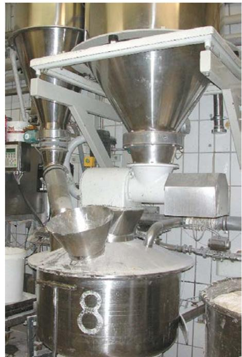
geschlossene Mehlausbringung mit Deckel und Absaugung
