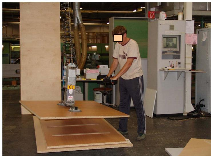
Vakuumhebehilfen für Platten
