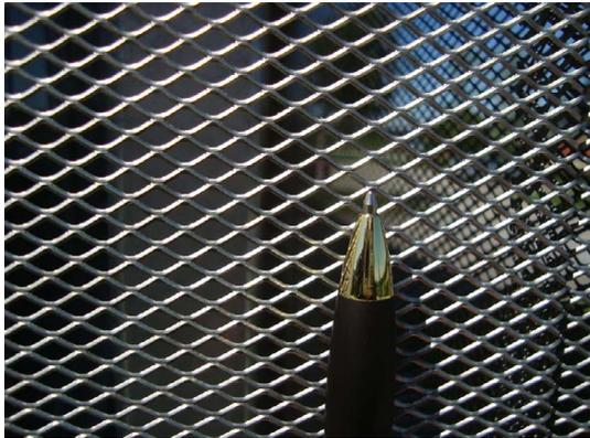
Metallgewebe aus Edelstahl. Maschenweite 8 x 4 mm, Drahtstärke etwa 1 mm.
