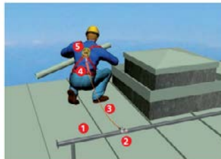
Auffangsystem mit Falldämpfer und horizontaler Anschlageinrichtung
